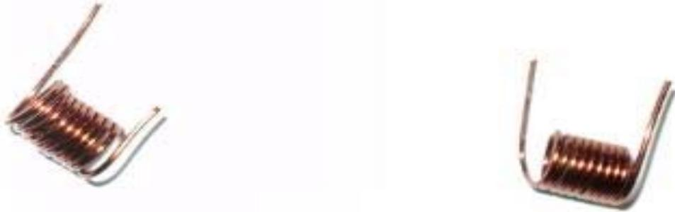
Figure(III.1.1.3): Bobines enroulées pour la détection GSM.
