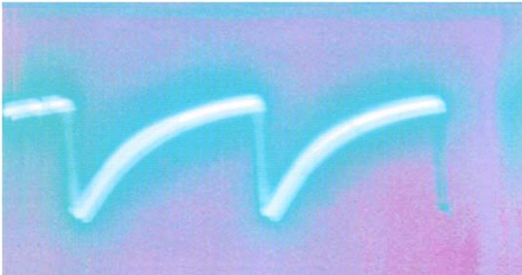
**Figure(IV.3.3.3.2.2): Signal à l'entrée du VCO Pin3.**
